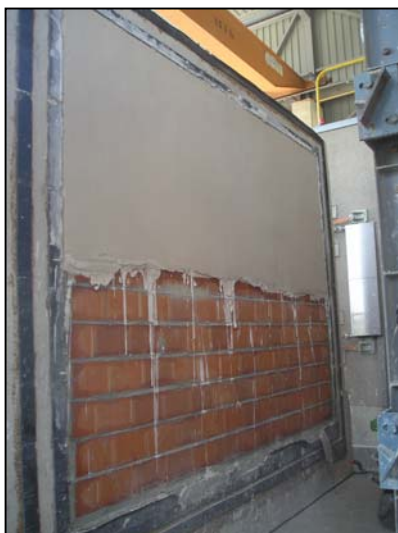
Fotografía 2 Construcción de la partición en el marco portamuestras
