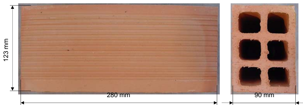
Figura 2: Dimensiones medidas del ladrillo hueco doble de 9
